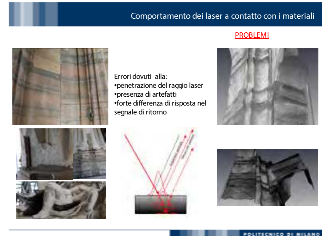
Fig. 9. Il Laser in rapporto ai materiali
