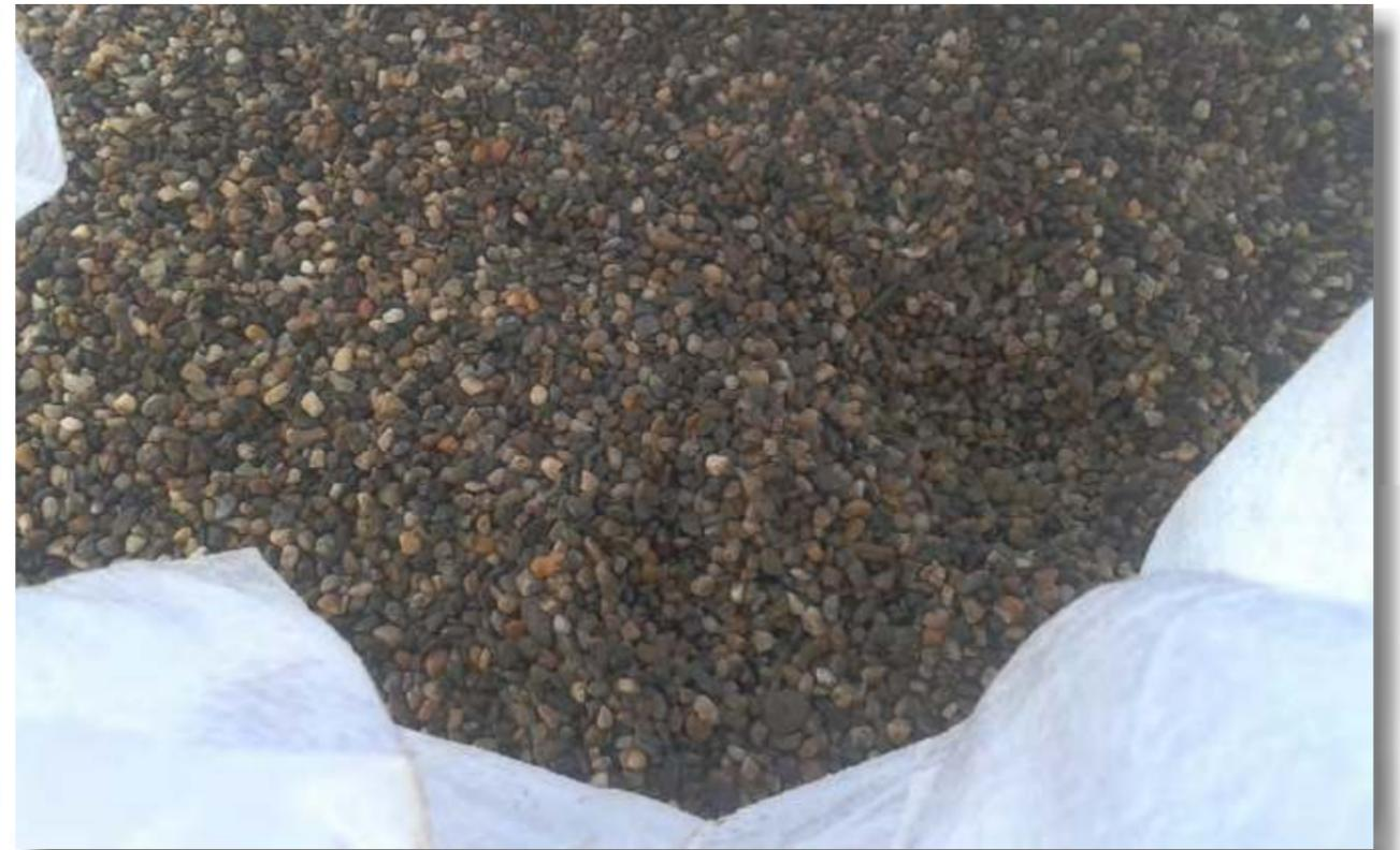
05: Particolare del "dreno", ghiaietto naturale calibrato da posizionare in prossimità dei tratti filtrati della colonna del pozzo
